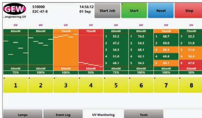
各ランプのUV強度は、グラフまたは表形式で表示することができます。ランプが設定ポイントに近づいたり、設定ポイントを超えたりした場合は、信号機の色で警告します。
