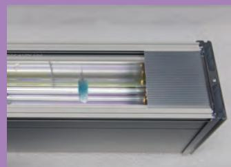
例: 石英ガラス窓のインキ汚れは、UV光量を48%低減させます。これはオンラインの静止型センサーでは検出できません。
